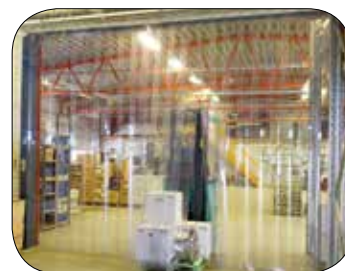
PVC-ridån håller värmen kvar i lokalen och går snabbt att köra igenom.
