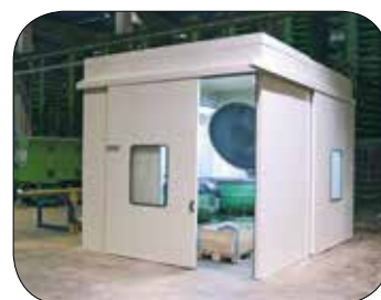
Bullerhus används för att dämpa mycket högljudna maskiner.
