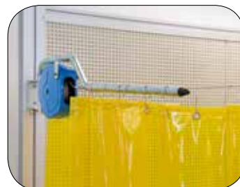
Draperihållare används där överligger ej kan användas, t.ex. vid traverspassering.
