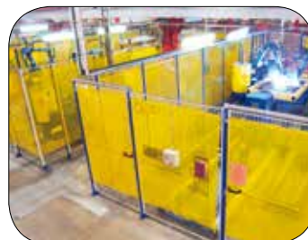
Svetsdraperier går enkelt att hänga på maskinskydd för att skydda mot svetsblänk och stänk.
