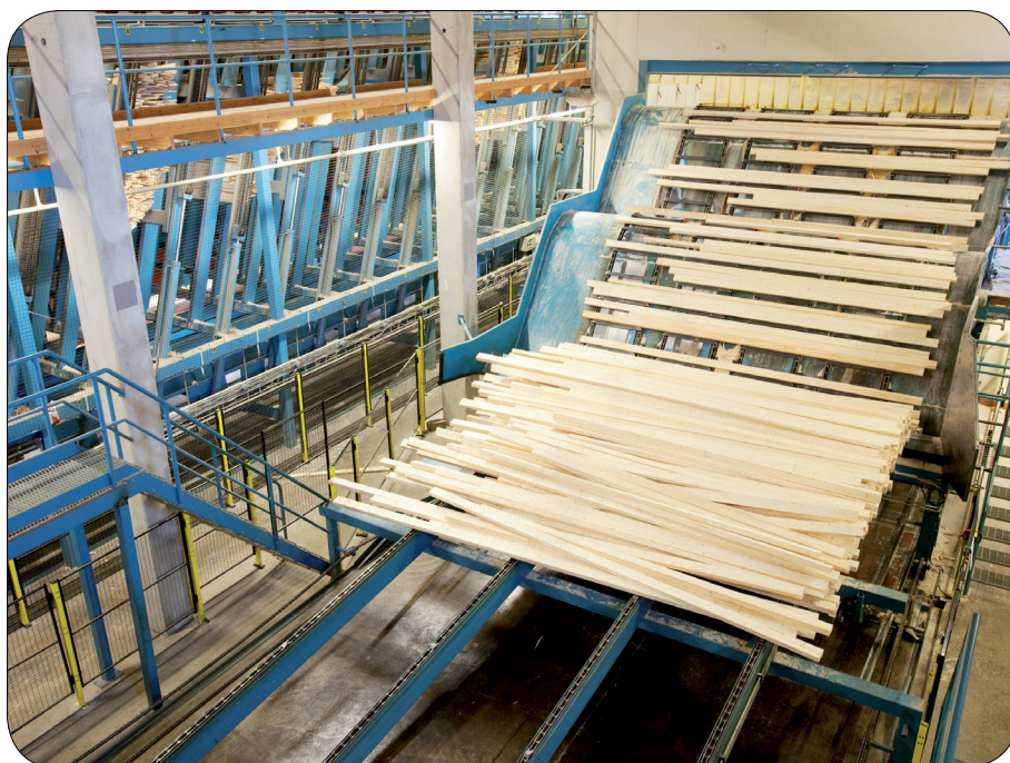
X-Guard skyddar mot fallande virke vid transportband.
