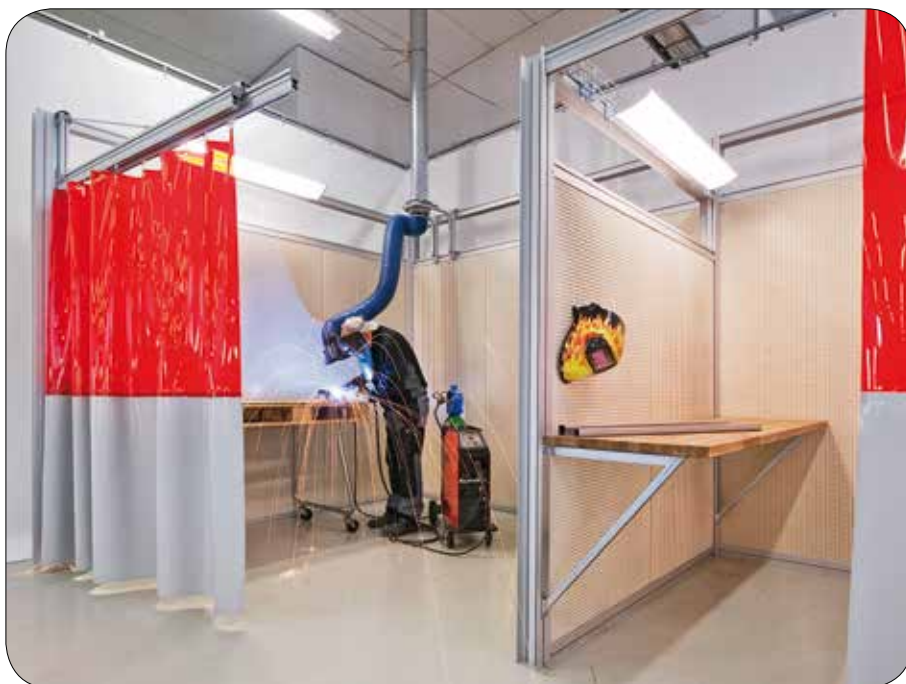
Svetsdraperier tar bort skadlig UV-strålning vid svetsning.
