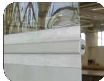
Aluminiumlist mellan de olika materialen förhindrar rynkbildning.
