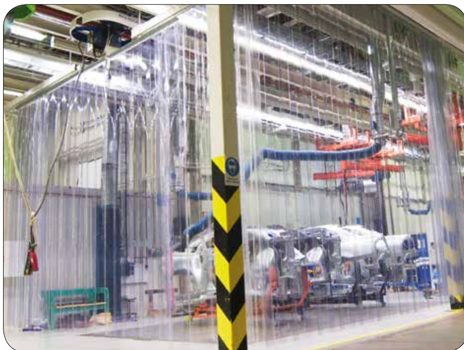
PVC-ridån skyddar mot svetsstänk och isocyanater.
