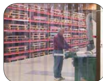
PVC-ridån stoppar sågdamm och dämpar buller.
